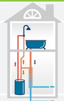
La chaleur des eaux utilisées préchauffe l'eau froide
